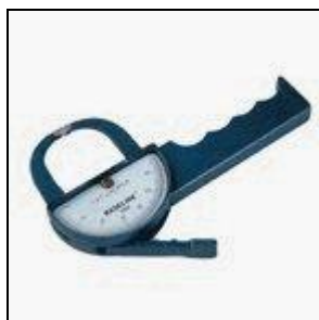
Slika 1 Kaliper-naprava za merjenje kožne gube
